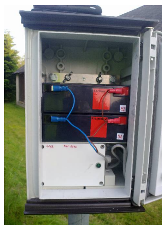
Obr. 12 – Radar Sierzege SR4 pro profilové měření rychlosti
