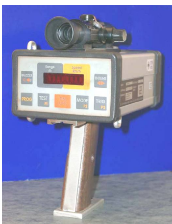
Obr. 11 – Laserová pistole RIEGL LR90-235/P
