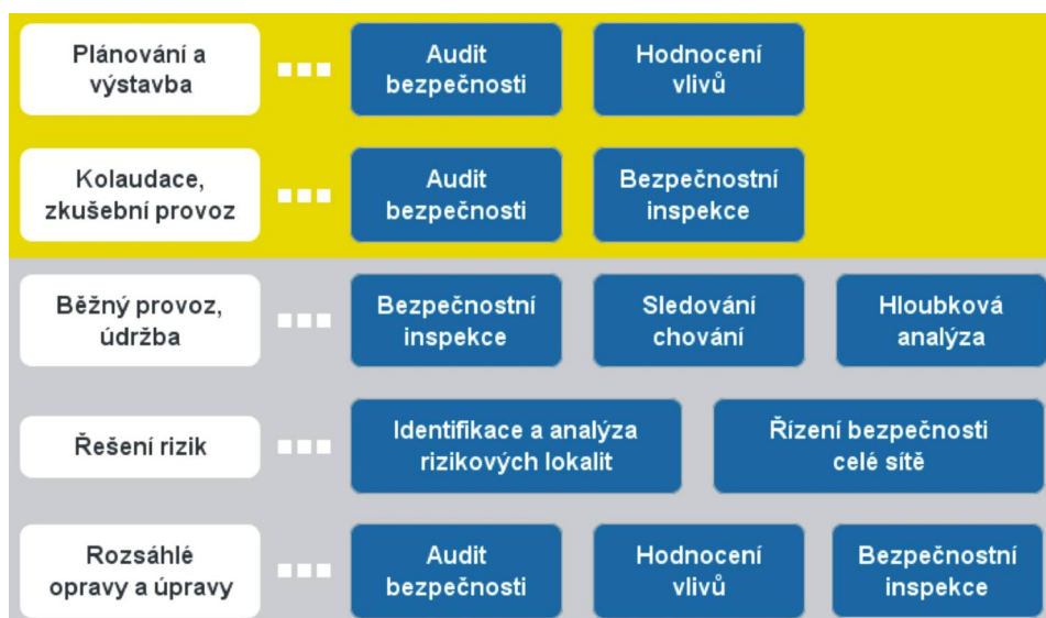
Obr. 5 – Nástroje bezpečného utváření komunikací dle fází životnosti komunikace (zdroj: http://www.audit-bezpecnosti.cz/ )
